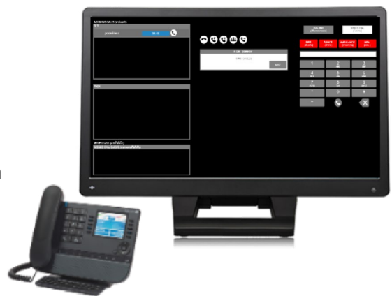
Figure 1 : Dispatch Console et poste IP Alcatel-Lucent Enterprise
