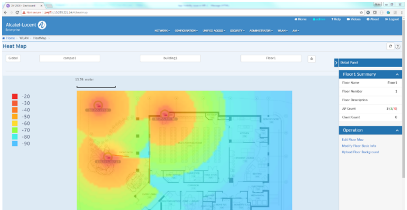
图3. 优化WiFi覆盖和无线性能的热图
