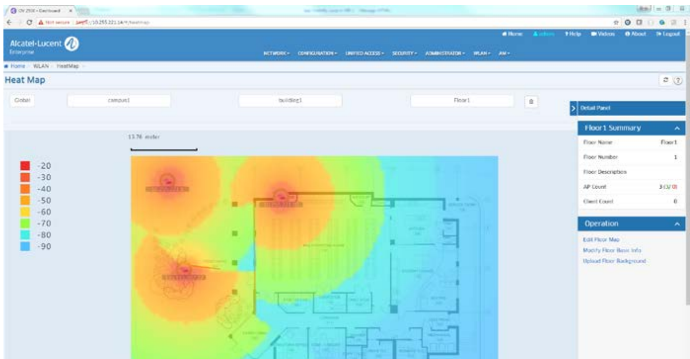
图3. 优化WiFi覆盖和无线性能的热图
