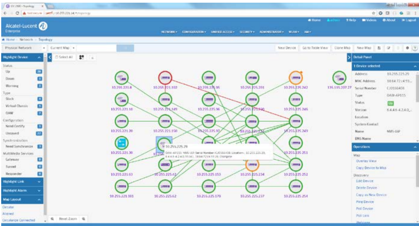
图1. 拓扑视图-有线和无线基础设施的高级映射功能
